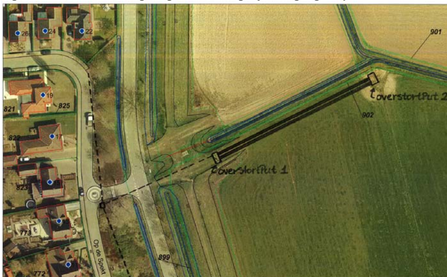
Figuur 3.1 Situering bergbezinkleiding bij watergang Dorp
